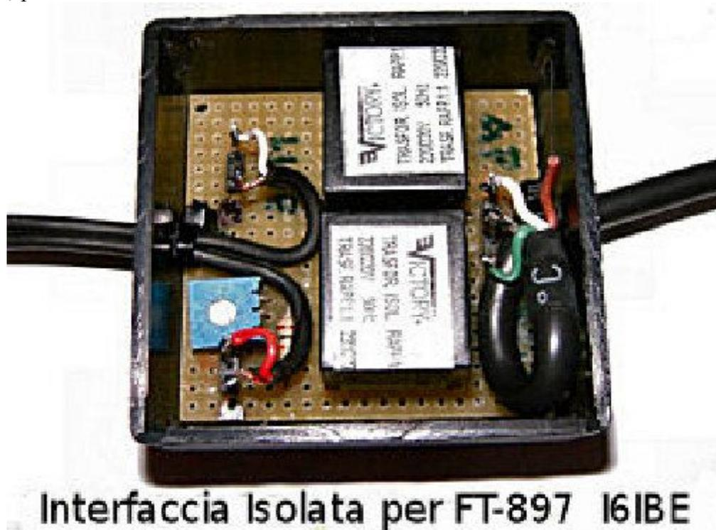
Questa e' la mia realizzazione, basetta millefori, poche saldature, senza fronzoli e funziona benissimo, il trimmer va regolato, durante i test per un input microfonico non troppo elevato evitando di intermodulare, un locale corrispondente o altro amico radioamatore potrà dirvi se la vostra TRACCIA osservata sul waterfall risulta modulata in modo corretto con IMD nella norma.
