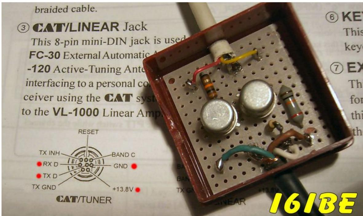
Anche qua' viene proposto un piccolissimo circuito stampato, non indispensabile, una basetta millefori si presta benissimo alla realizzazione di un prototipo, io ho testato anche quella realizzata con l'integrato max232 sia un KIT sempre con max232 (i5xww) ottenendo sempre risultati ottimi
